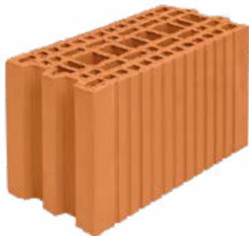
Porotherm 20 предназначен для заполнения проемов в монолитно-каркасном здании, а также для возведения внутренних стен и межквартирных перегородок. Керамический блок Porotherm 20 обладает тремя рядами утолщенных стенок, их общая толщина – 36 мм. Благодаря такому дизайну обеспечивается максимальная нагрузка на вырыв фасадных анкеров из кладки, что позволяет крепить в стены кронштейны подсистемы вентилируемых фасадных систем и тяжелое оборудование без применения химических анкеров.
