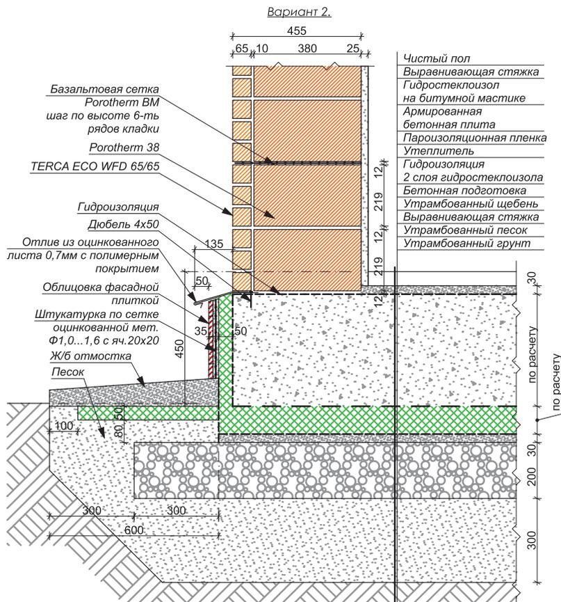
СТЕНА, ТИП 2. ФУНДАМЕНТАЛЬНАЯ ПЛИТА
