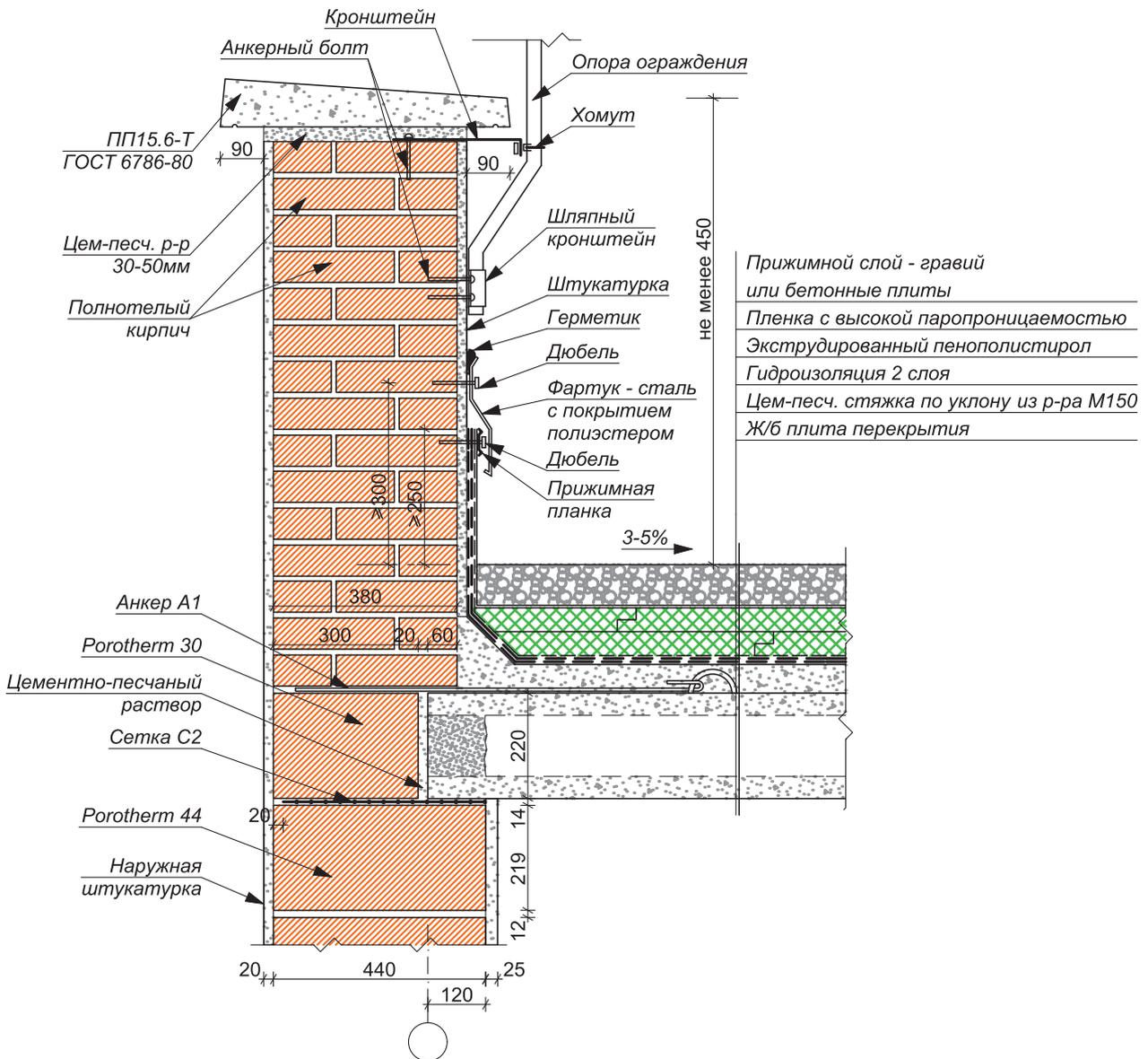
УСТРОЙСТВО ПАРАПЕТА И ЭКСПЛУАТИРУЕМОЙ
