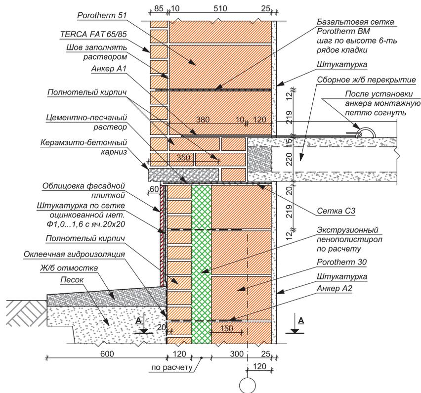
СТЕНА, ТИП 2. ОТАПЛИВАЕМЫЙ ПОДВАЛ.
