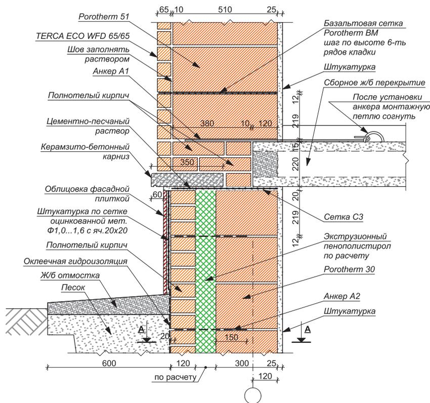
СТЕНА, ТИП 2. ОТАПЛИВАЕМЫЙ ПОДВАЛ.
