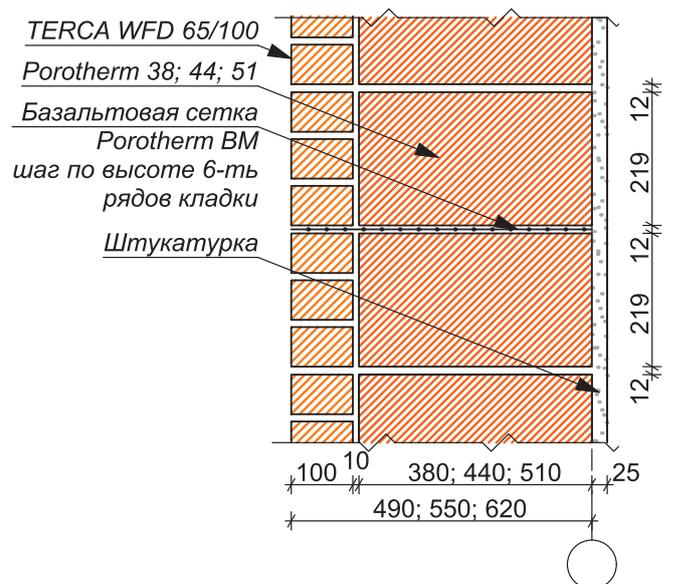
Для несущих стен используются все типы стен. Толщина стен определяется расчетно в зависимости от передаваемой на них нагрузки и теплотехнических требований.
