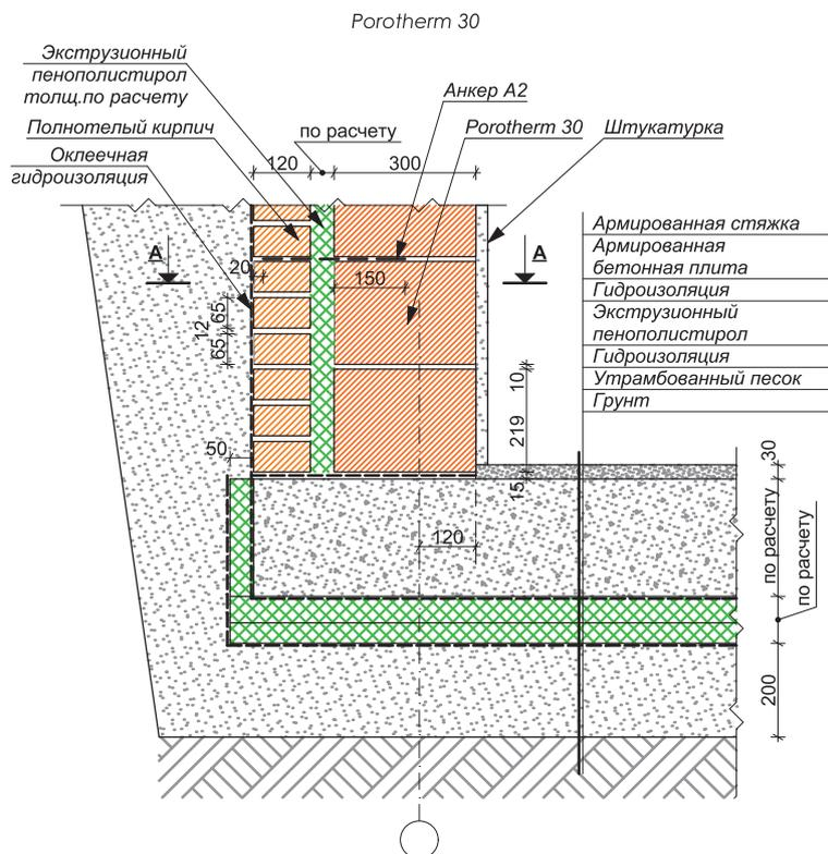
СТЕНА, ТИП 2. ОТАПЛИВАЕМЫЙ ПОДВАЛ.
