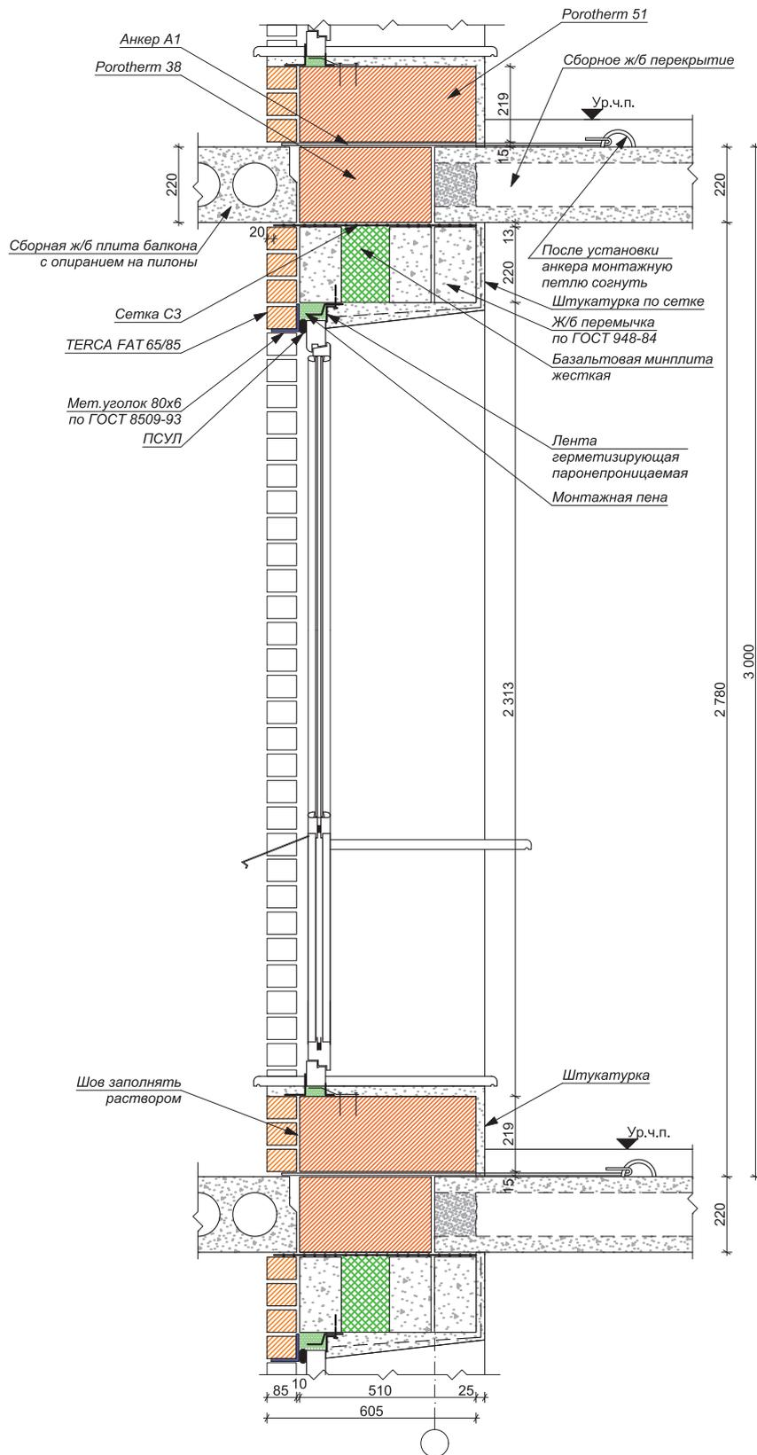
СТЕНА, ТИП 2. СЕЧЕНИЕ ПО БАЛКОННОЙ ДВЕРИ
