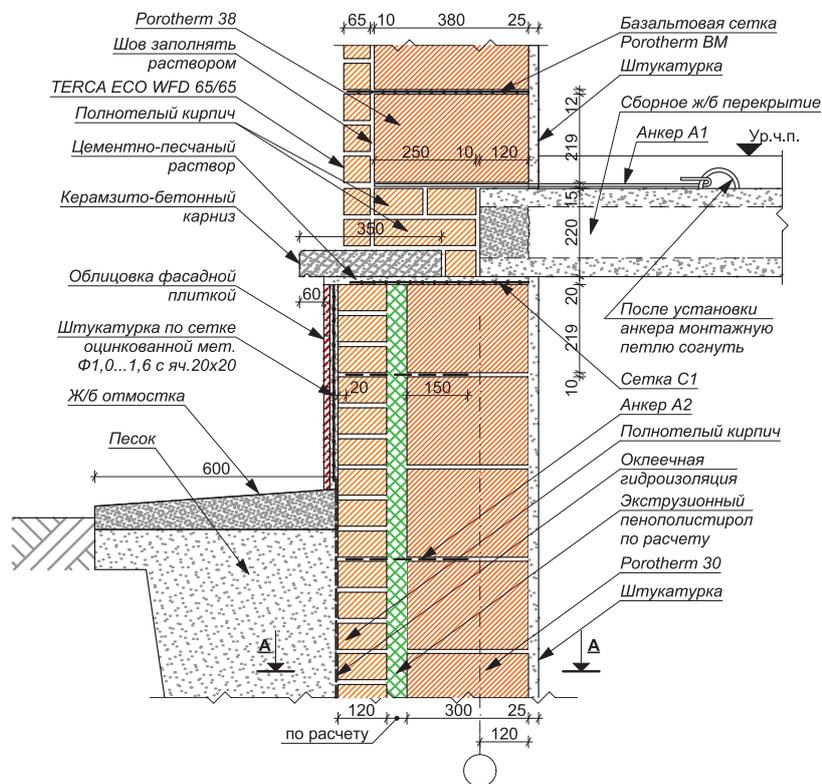
СТЕНА, ТИП 2. ОТАПЛИВАЕМЫЙ ПОДВАЛ.
