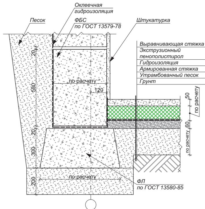
СТЕНА, ТИП 1. ОТАПЛИВАЕМЫЙ ПОДВАЛ.
