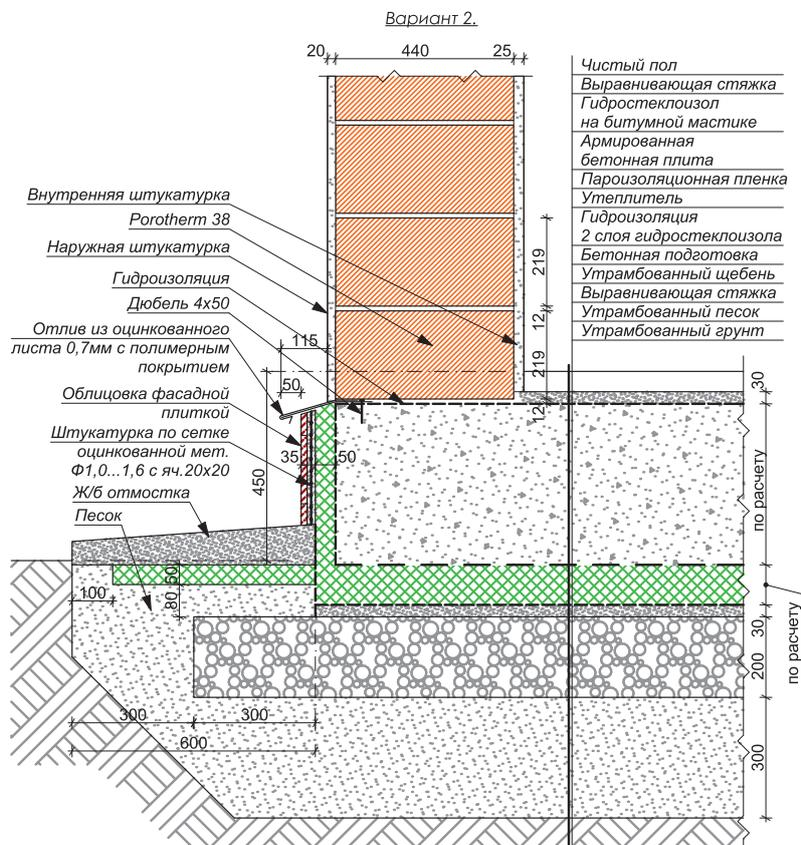
СТЕНА, ТИП 1. ФУНДАМЕНТАЛЬНАЯ ПЛИТА
