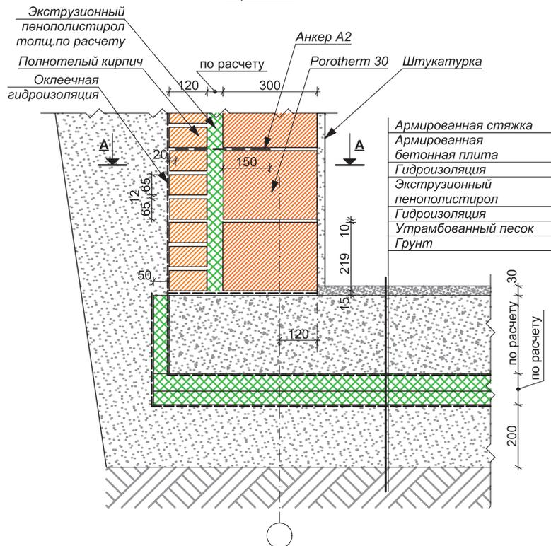
СТЕНА, ТИП 1. ОТАПЛИВАЕМЫЙ ПОДВАЛ.
