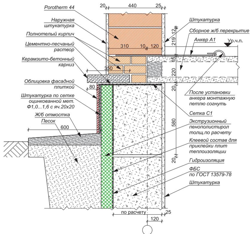
СТЕНА, ТИП 1. НЕОТАПЛИВАЕМЫЙ ПОДВАЛ.
