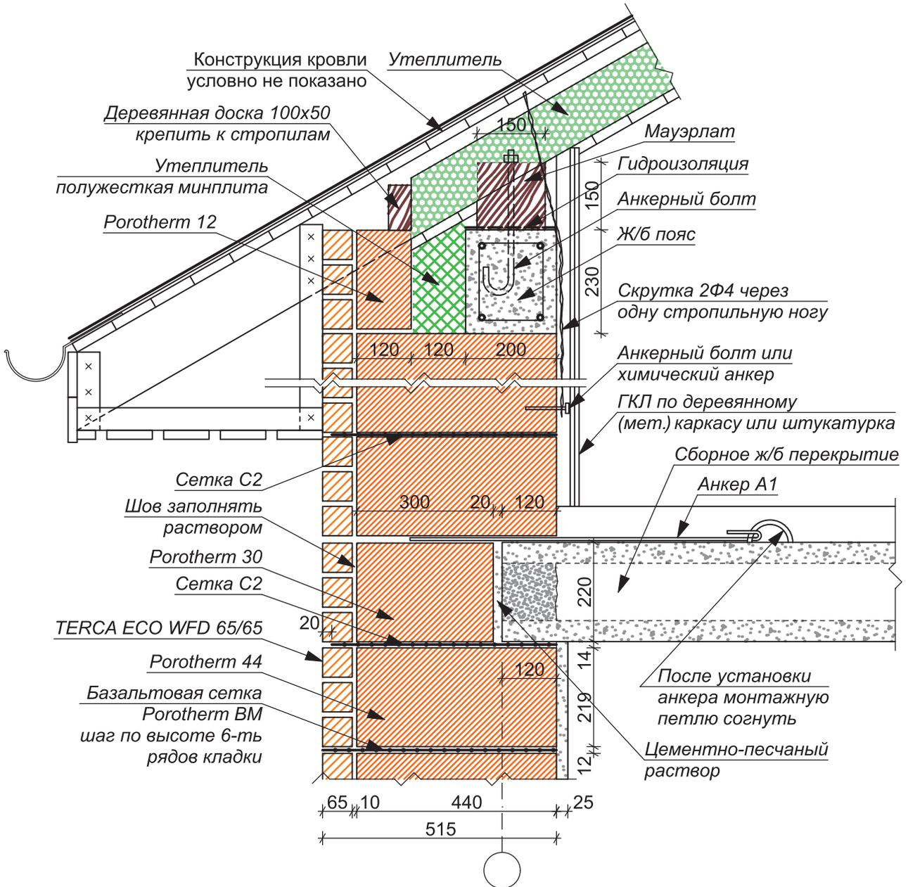
ПРИМЫКАНИЕ НЕСУЩЕЙ СТЕНЫ К СКАТНОЙ (БЕЗРАСПОРНОЙ) КРОВЛЕ НАРУЖНОЙ СТЕНЫ ИЗ POROTHERM 44 (ТЕПЛЫЙ ЧЕРДАК)
