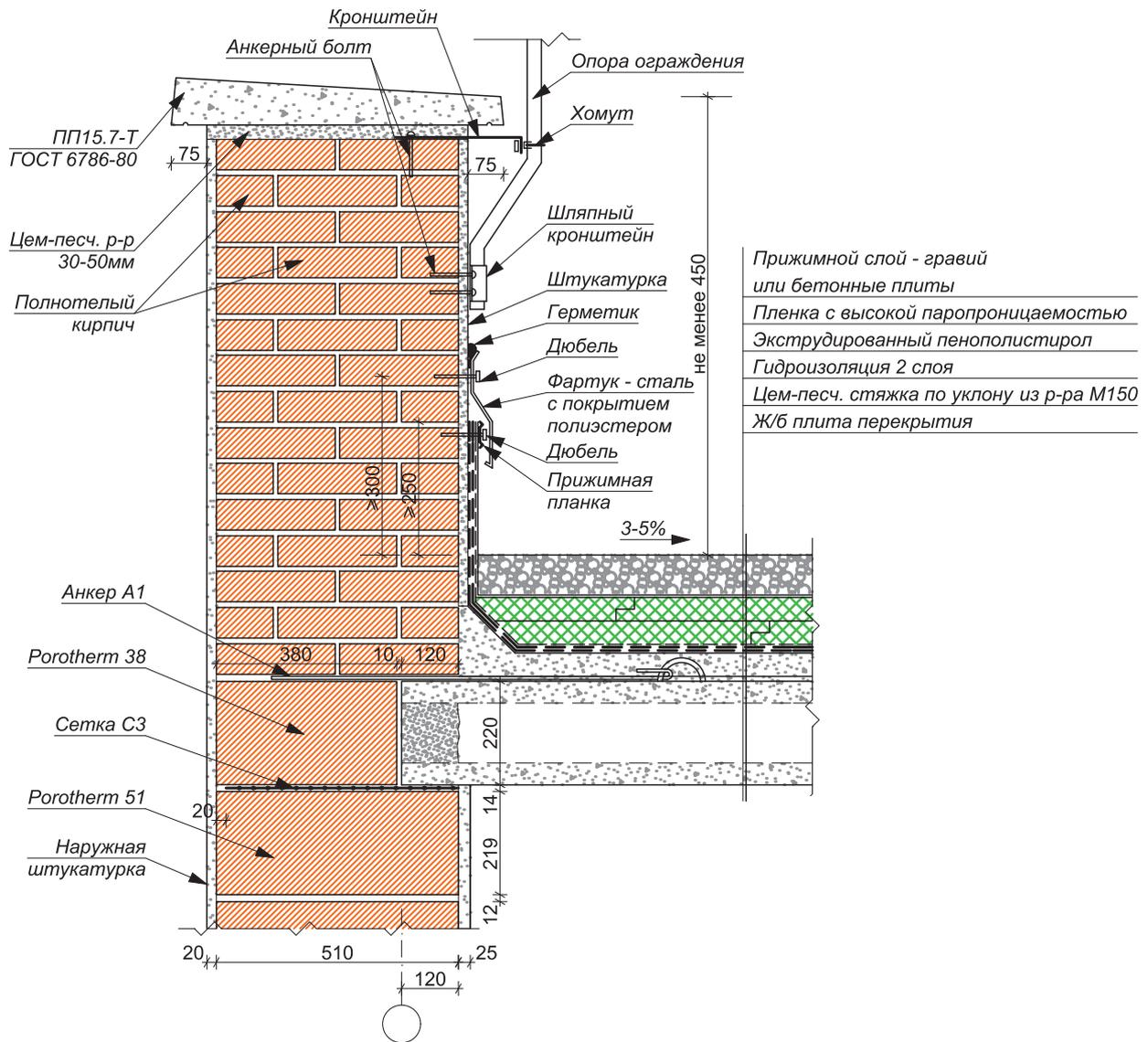
УСТРОЙСТВО ПАРАПЕТА И ЭКСПЛУАТИРУЕМОЙ
