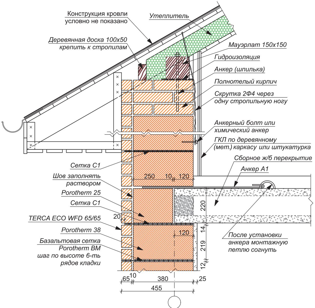
ПРИМЫКАНИЕ НЕСУЩЕЙ СТЕНЫ К СКАТНОЙ (БЕЗРАСПОРНОЙ) КРОВЛЕ НАРУЖНОЙ СТЕНЫ ИЗ POROTHERM 38 (ТЕПЛЫЙ ЧЕРДАК)
