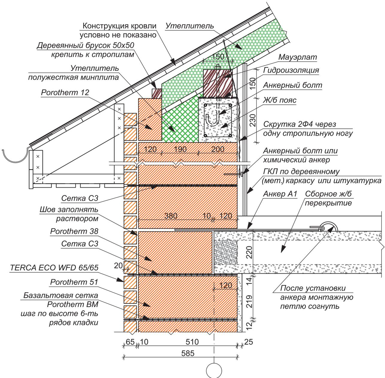
ПРИМЫКАНИЕ НЕСУЩЕЙ СТЕНЫ К СКАТНОЙ (БЕЗРАСПОРНОЙ) КРОВЛЕ НАРУЖНОЙ СТЕНЫ ИЗ POROTHERM 51 (ТЕПЛЫЙ ЧЕРДАК)
