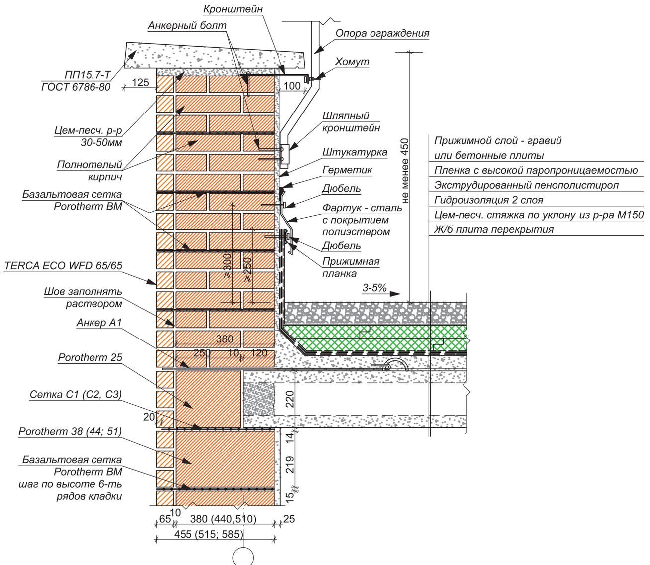
УСТРОЙСТВО ПАРАПЕТА И ЭКСПЛУАТИРУЕМОЙ
